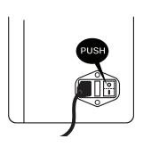
6. PLUG IN THE POWER CABLE AND TURN THE MACHINE ON USING THE POWER SWITCH LOCATED ON THE BACK.
